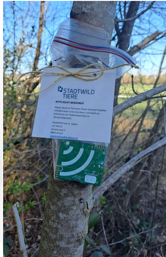
Abb. 7: AudioMoth der Firma Open Acoustics Devices (links) an einem Test-Aufnahmestandort (rechts). Der Plastikbeutel bewährte sich als Feuchtigkeitsschutz, der die Aufnahmequalität kaum beeinträchtigte.
